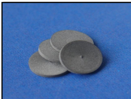
Figura 7 - discos de titânio com 0,5 mm de espessura por 5,0 mm de diâmetro
