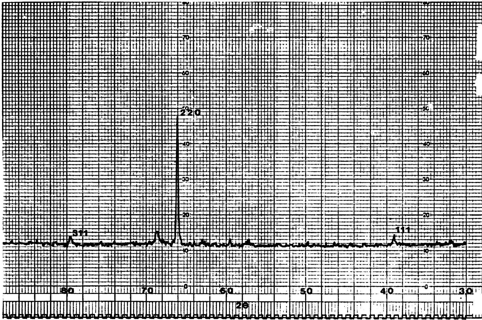
FIGURA IV-1 : DIFRATOGRAMA - LIGA CO 2 NEAL.
