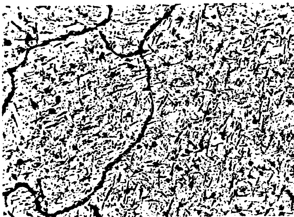
Figura 15b - Zr bruto de fusão com resfriamento rápido, estrutura semelhante a martensita. Aumento: 640x
