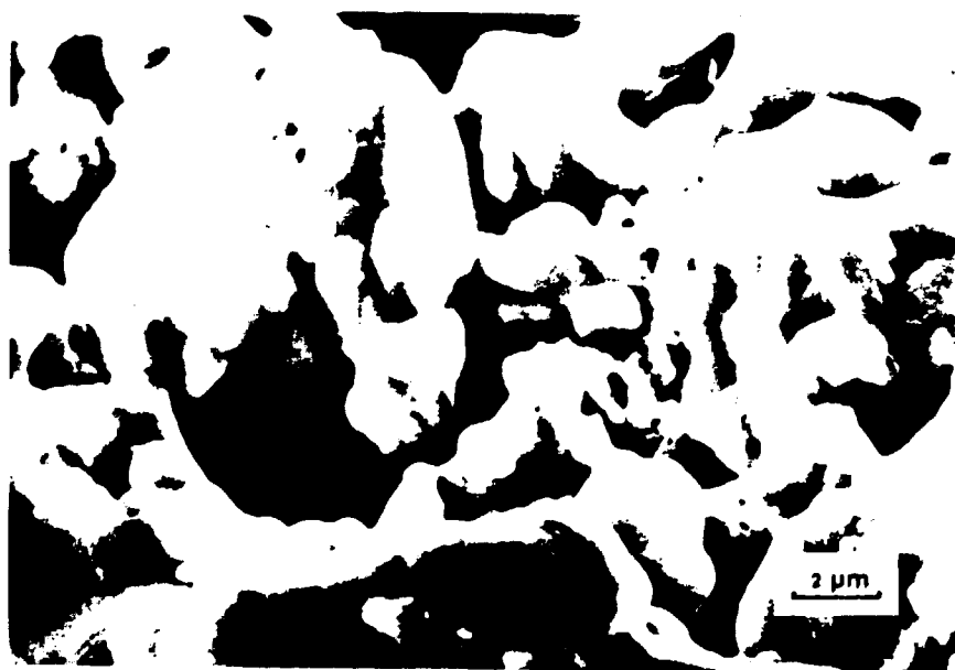
Fig. 3.9 - Microscopia eletrônica de varredura do filme C3, sobre substrato de alumina, duplamente sinterizado: ao ar, a 950°C por 40 min e sob fluxo de O 2 , nas mesmas condições.
