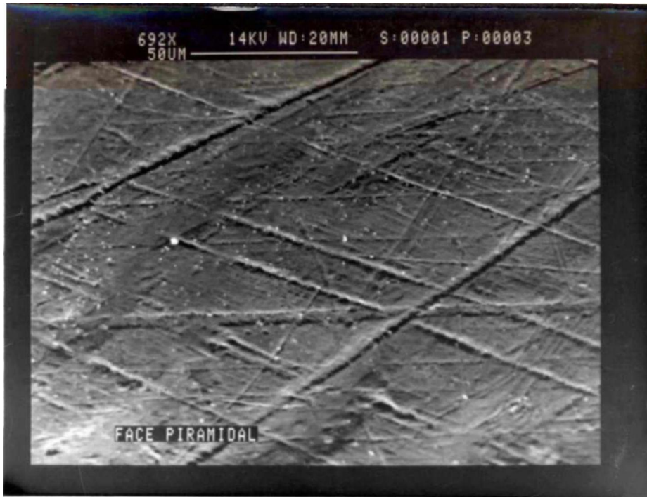
Foto 9: Face piramidal de um cristal crescido a 42°C
