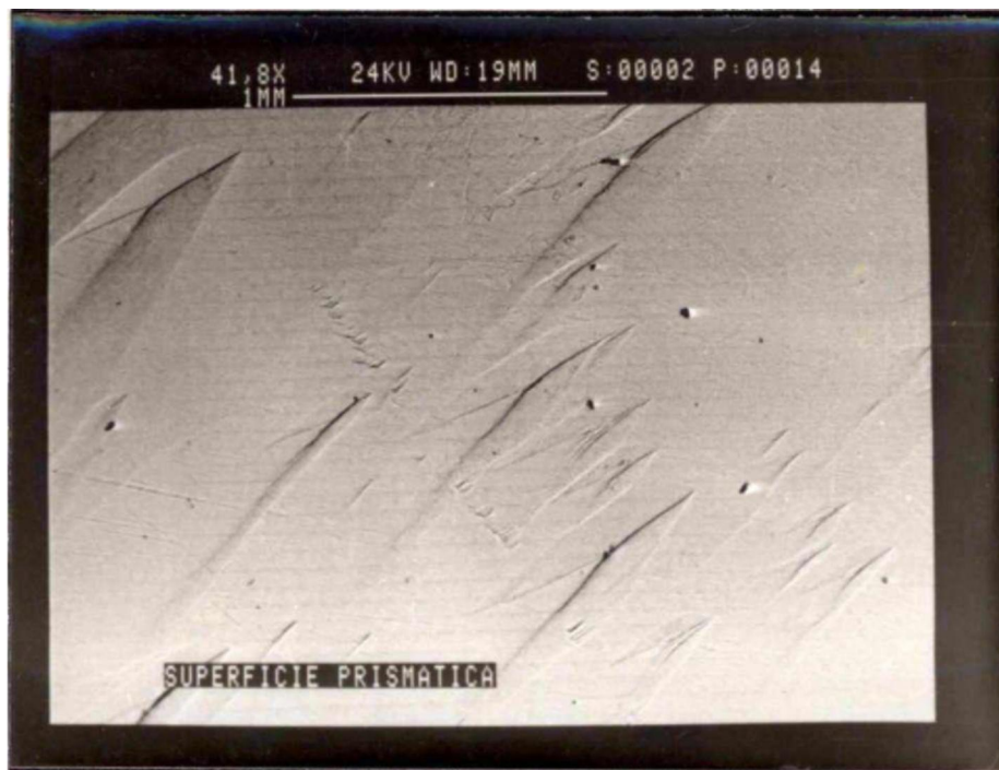
Foto 8: Face prismática de um cristal crescido a 42^{\circ}\text{C}
