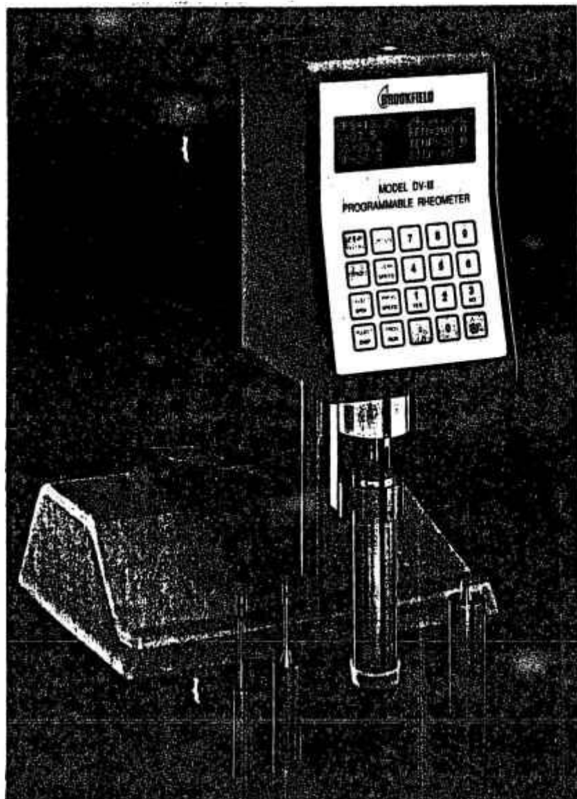
Figura 3 - Viscosímetro rotacional Brookfield/DV - III programável com vários tipos de spindle que podem ser utilizados na medida da viscosidade das suspensões juntamente com o adaptador de pequenas amostras.
