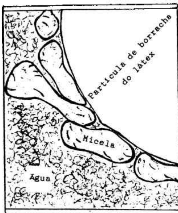
Figura 12 - Formação das micelas de sabão na superfície das partículas de látex.
