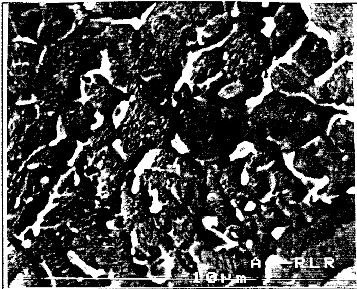
Micrografia 3 - MEV da liga Zr-1,5% Nb, laminada 60%, recozida a 700 °C por 4 h. Observa-se uma estrutura bifásica \alpha_{Zr}\beta_{Zr} , as setas indicam as posições de análise para o Zr e Nb por EDS.
