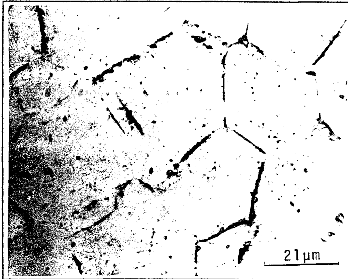
Micrografia 15 - MO da liga Zr-0,25% Nb e laminada 60% recozida 750 °C por 1 h. Observa-se a completa recristalização completa na fase \alpha_{Zr}
