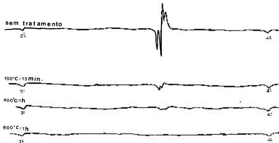
Fig.6.4 - Decaimento do sinal RPE do  $\text{CaSO}_4:\text{Dy}$  (0,1% mol Dy) mediante diferentes tratamentos térmicos.
