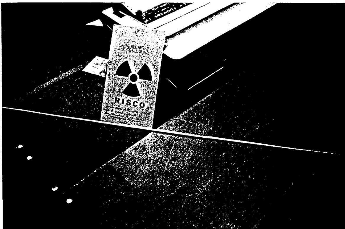
**Fotografia 4.2.1 - Preparação do Fio de Ativação com Proteção de Alumínio**
