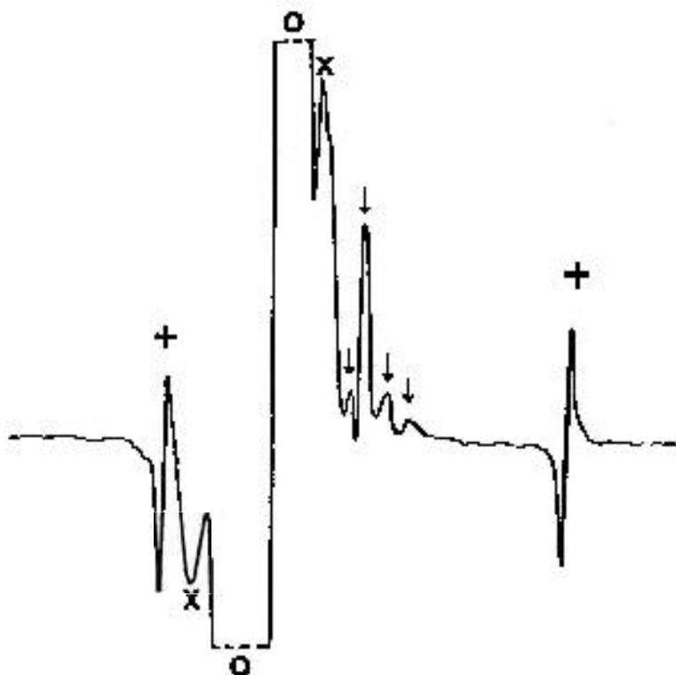
Figura 19. Espectro de RPE à temperatura ambiente no ar para uma dose de 100kGy, medido logo após a irradiação.
