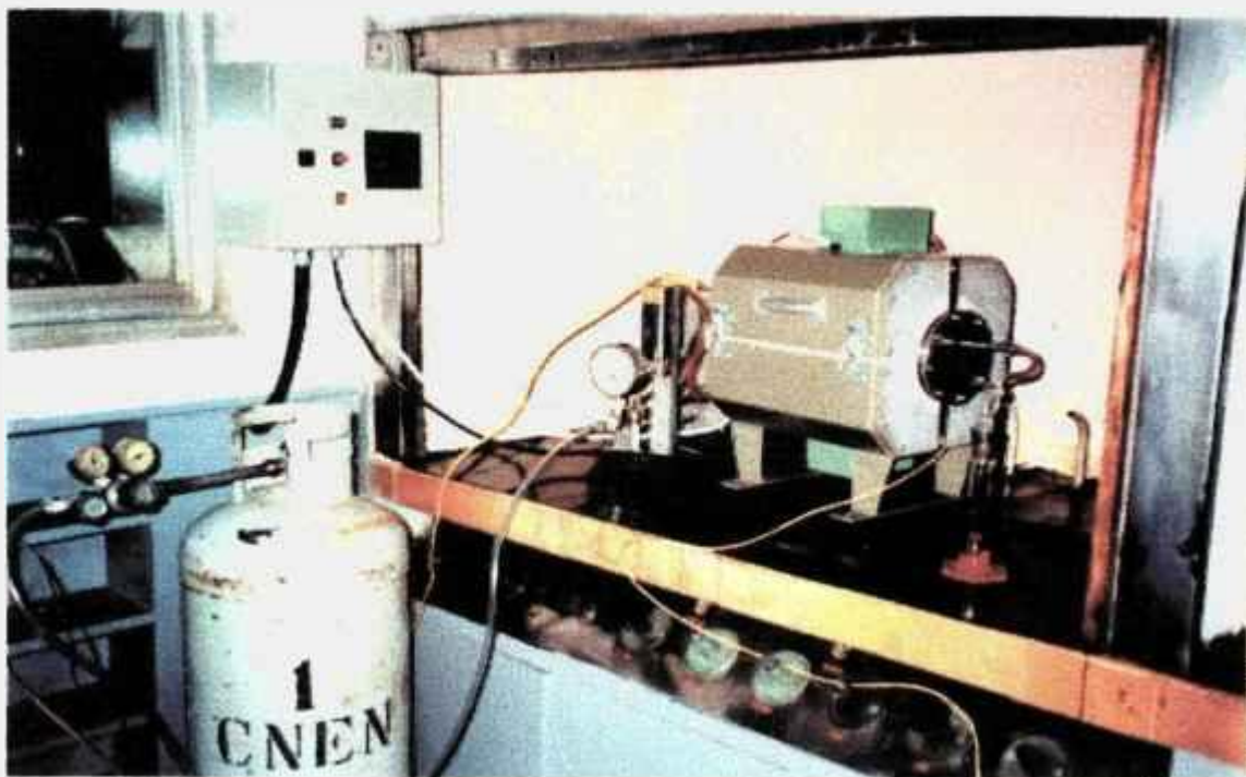
Figura 3.3 - Visão frontal da unidade de decomposição catalítica da amônia.
