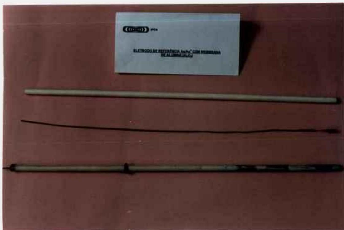
**FIGURA 19.** Visão do Eletrodo de Referência
