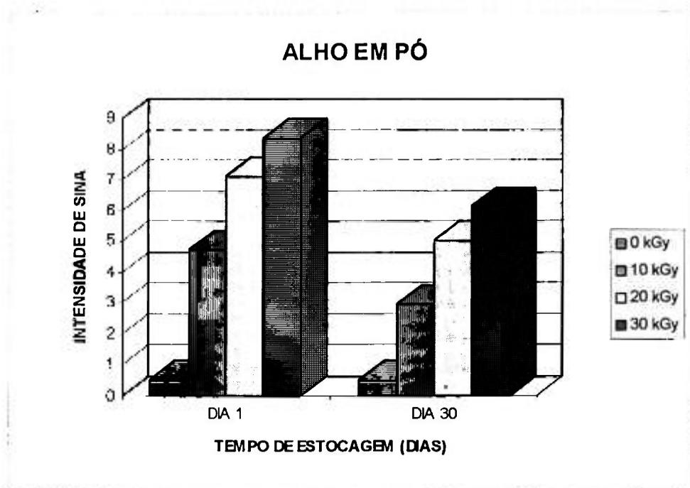
**Figura 33** - Decaimento do sinal de RPE com o tempo de estocagem, para o alho em pó, estocado à temperatura ambiente.
