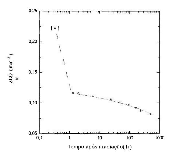
Figura 4.17: Decaimento da resposta das amostras de vidro nacional (lote 1) irradiadas com 2,2 kGy de <sup>60</sup> Co, após tratamento térmico de 80 °C durante 1 hora e armazenadas à temperatura ambiente. Medidas obtidas com densitômetro.
