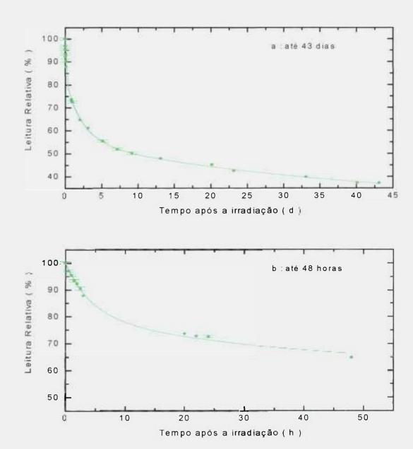
Figura 4.10 : Decaimento da resposta das amostras de vidro importado à temperatura ambiente, irradiadas com 10 kGy de <sup>60</sup>Co. Medidas de densidade óptica relativa obtidas com densitômetro.
