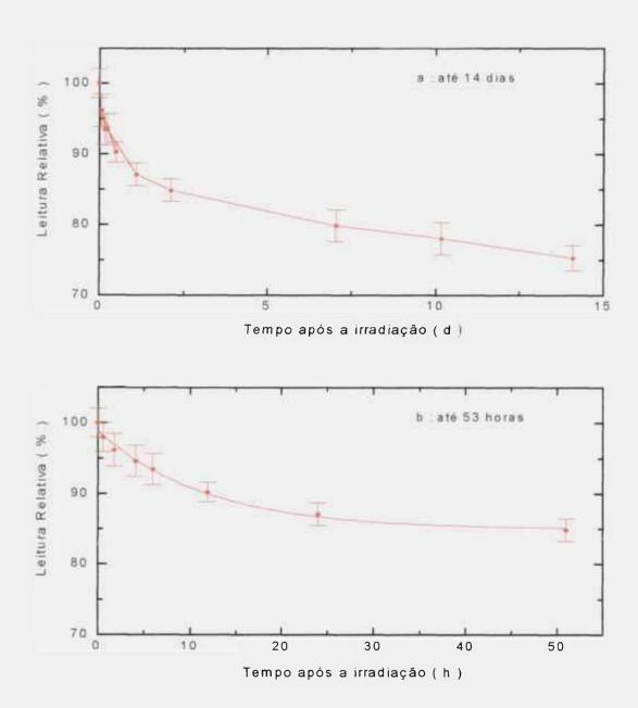
Figura 4.16: Decaimento da resposta das amostras de vidro nacional à temperatura de - 16,5 °C, irradiadas com 2,3 kGy de <sup>60</sup>Co. Medidas de densidade optica relativa obtidas com espectrofotômetro.
