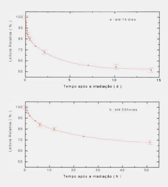
Figura 4.14: Decaimento da resposta das amostras de vidro nacional à temperatura ambiente, irradiadas com 2,3 kGy de <sup>60</sup>Co. Medidas de densidade óptica relativa obtidas com espectrofotômetro.
