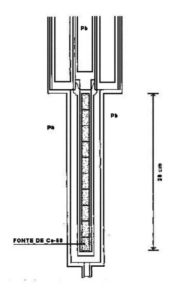
Figura 3.1 : Nuclídeo radioativo <sup>60</sup>Co, na forma de bastão ( lápis ). Encapsulado em um tubo de aço inox de 4 mm de espessura.
