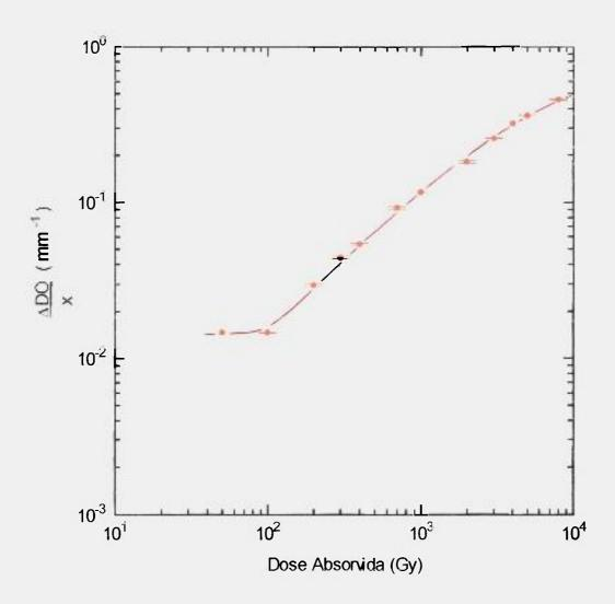
Figura 4.7 : Curva de calibração de amostras de vidro nacional irradiadas com <sup>60</sup>Co ( 1,09 kGy/h ). Medidas de variação da densidade óptica por espessura da amostra, em função da dose absorvida. Medidas de densidade óptica obtidas com densitômetro.
