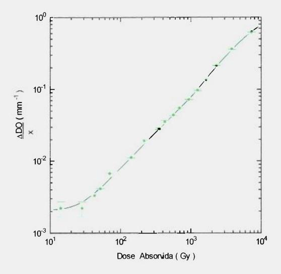
Figura 4.4 : Curva de calibração de amostras de vidro importado irradiadas com <sup>60</sup>Co. Medidas de variação da densidade óptica por espessura da amostra, em função da dose absorvida. Medidas de densidade óptica obtidas com espectrofotômetro.
