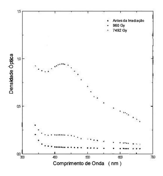
Figura 4.2 : Espectro de absorção de amostras de vidro importado, antes e após a irradiação com diferentes doses de <sup>60</sup>Co.
