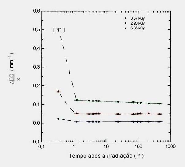
Figura 4.22 : Decaimento da resposta das amostras de vidro nacional ( lote 4 ) irradiadas com <sup>60</sup> CO, após tratamento térmico de 130 °C durante 10 minutos e armazenadas à temperatura ambiente. Medidas obtidas com espectrofotômetro.
