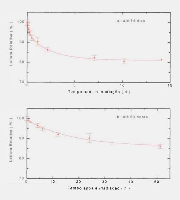
Figura 4.15 : Decaimento da resposta das amostras de vidro nacional à temperatura de - 16,5°C, irradiadas com 2,3 kGy de <sup>60</sup>C0. Medidas de densidade óptica relativa obtidas com densitômetro.
