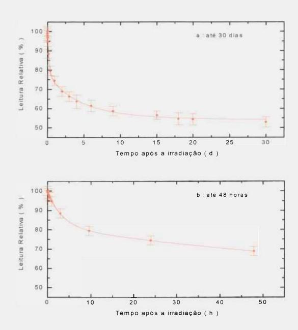
Figura 4.12 : Decaimento da resposta das amostras de vidro nacional à temperatura ambiente, irradiadas com 2,3 kGy de <sup>60</sup>Co.
