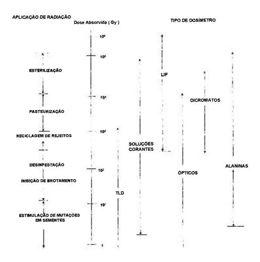
Figura 1.1 : Aplicação de processos de radiação de altas doses e sistemas dosimétricos aplicados<sup>[14]</sup>.
