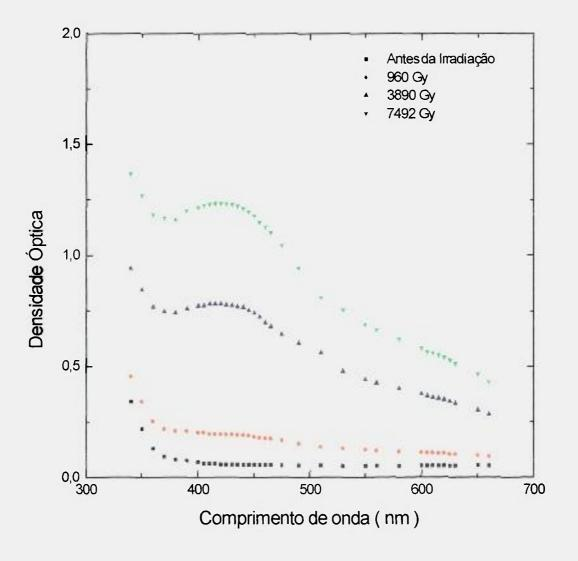
Figura 4.1 : Espectro de absorção de amostras de vidro nacional, antes e após a irradiação com diferentes doses de <sup>60</sup>Co.
