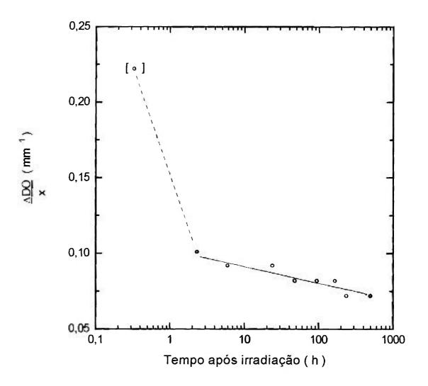
Figura 4.18: Decaimento da resposta das amostras de vidro nacional ( lote 2 ) irradiadas com 2,2 kGy de <sup>60</sup> Co, após tratamento térmico de 80 °C durante 2 horas e armazenadas à temperatura ambiente. Medidas obtidas com densitômetro.
