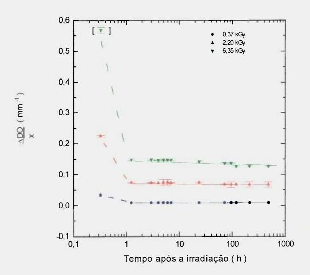
Figura 4.21: Decaimento da resposta das amostras de vidro nacional (lote 4) irradiadas com <sup>60</sup>Co, após tratamento térmico de 130 °C durante 10 minutos e armazenadas `a temperatura ambiente. Medias obtidas com densitômetro.
