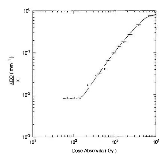
Figura 4.6 : Curva de calibração de amostras de vidro importado irradiadas com <sup>60</sup>Co. Medidas de variação da densidade óptica por espessura da amostra, em função da dose absorvida. Medidas de densidade óptica obtidas com densitômetro.
