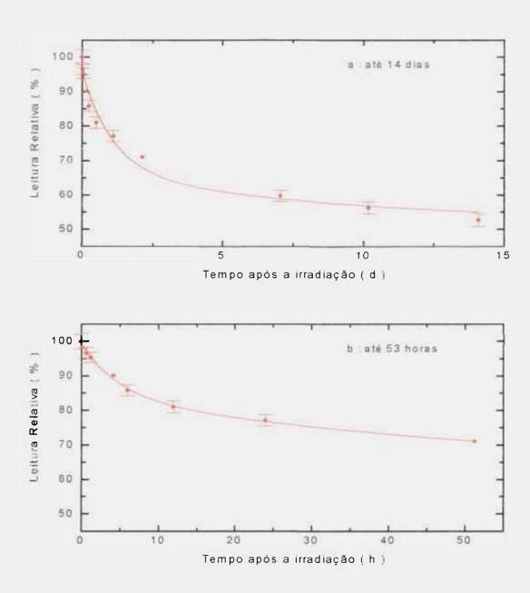
Figura 4.13 : Decaimento da resposta das amostras de vidro nacional `a temperatura ambiente, irradiadas com 2,3 kGy de <sup>60</sup>Co. Medidas de densidade óptica relativa obtidas com densitômetro.
