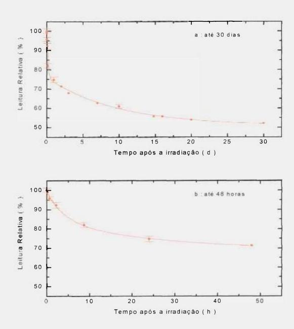
Figura 4.11 : Decaimento da resposta das amostras de vidro nacional à temperatura ambiente, irradiadas com 2,3 kGy de <sup>60</sup>Co. Medidas de densidade óptica relativa obtidas com densitômetro.
