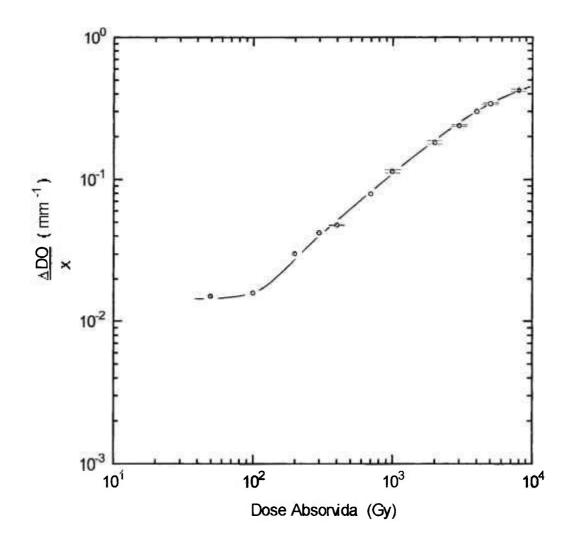
Figura 4.8 : Curva de calibração de amostras de vidro importado irradiadas com <sup>60</sup>Co ( 1,09 kGy/h ). Medidas de variação da densidade óptica por espessura da amostra, em função da dose absorvida. Medidas de densidade óptica obtidas com densitômetro.
