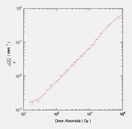
Figura 4.3 : Curva de calibração de amostras de vidro nacional irradiadas com <sup>60</sup>Co. Medidas de variação da densidade óptica por espessura da amostra, em função da dose absorvida. Medidas de densidade óptica obtidas com espectrofotômetro.
