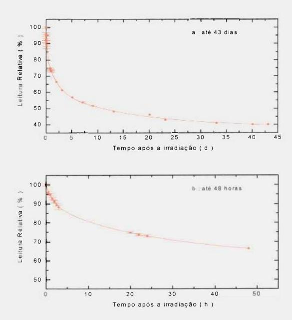
Figura 4.9: Decaimento da resposta das amostras de vidro nacional à temperatura ambiente, irradiadas com 10 kGy de <sup>60</sup>Co. Medidas de densidade óptica relativa obtidas com densitômetro.
