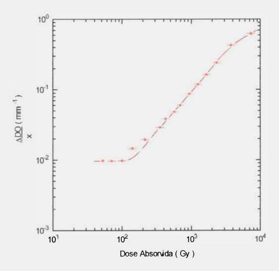
Figura 4.5 : Curva de calibração de amostras de vidro nacional irradiadas com <sup>60</sup>Co. Medidas de variação da densidade óptica por espessura da amostra, em função da dose absorvida. Medidas de densidade óptica obtidas com densitômetro.
