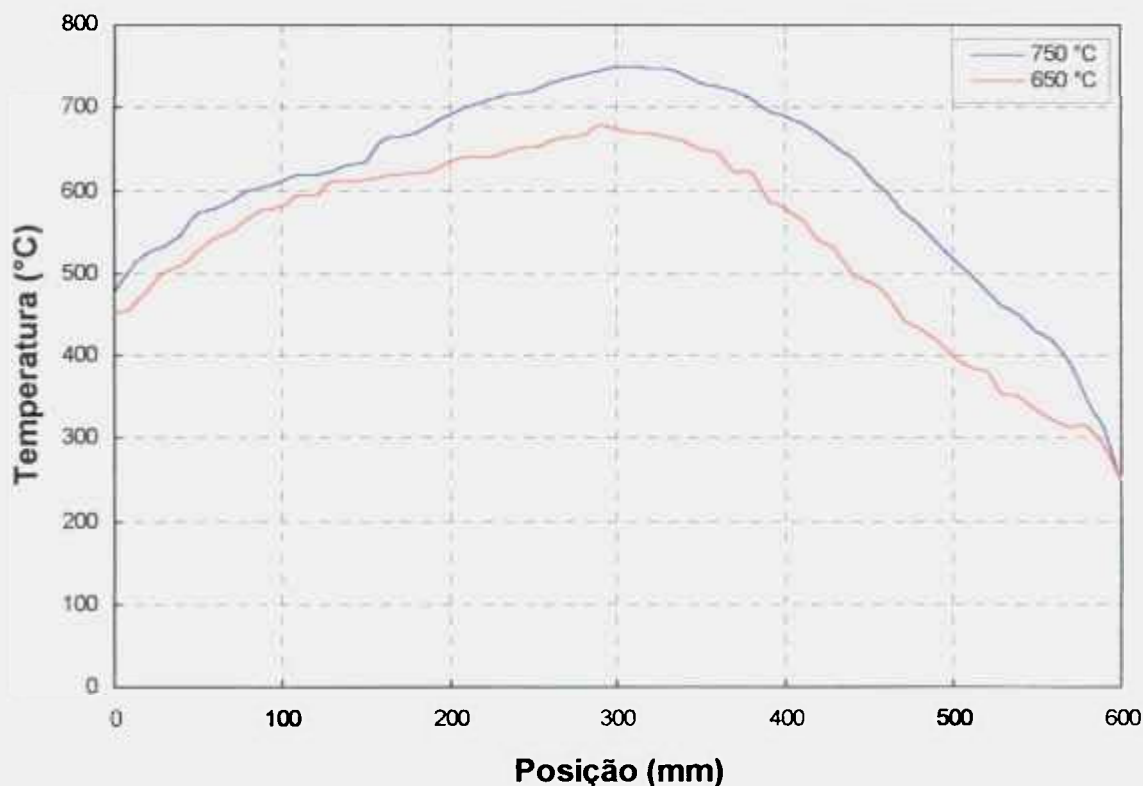
Figura 13: Perfil de temperatura do forno utilizado no crescimento de cristais de CsI(Tl).
