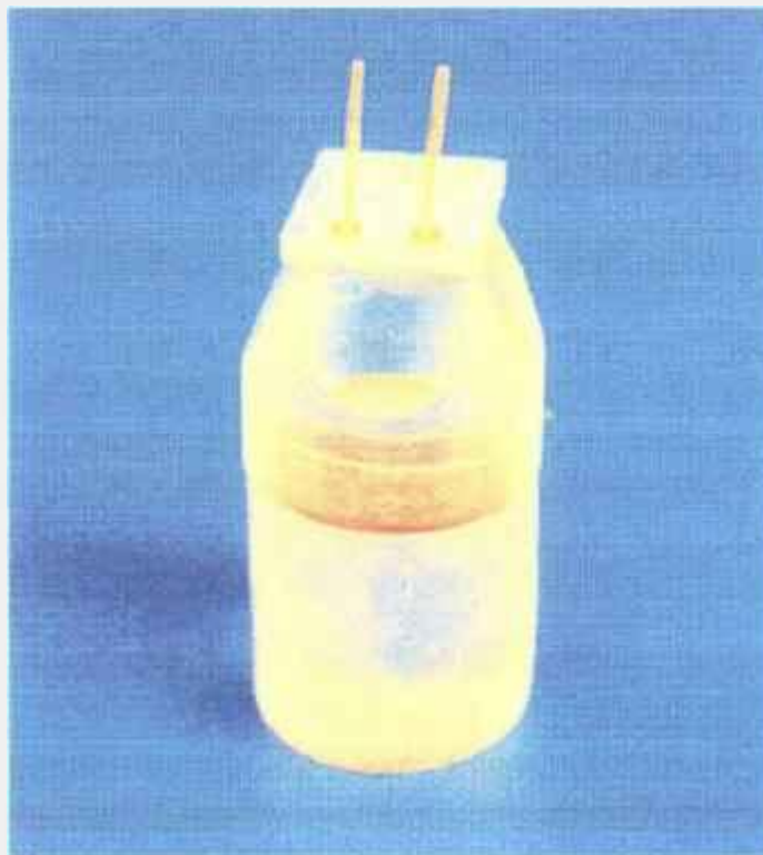
Figura 20: Cristal de CsI(Tl) acoplado ao fotodiodo tipo PIN (Hamamatsu modelo S3590-3) com área sensível de 10 \times 10 \text{mm}^2 .
