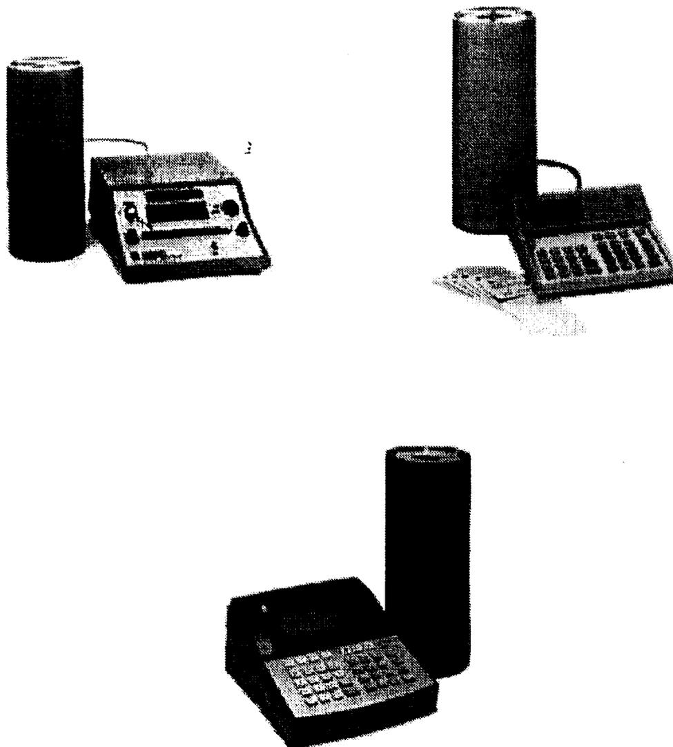
Figura 2.2: Calibradores de dose comerciais da Capintec, Pittsburgh, EUA.
