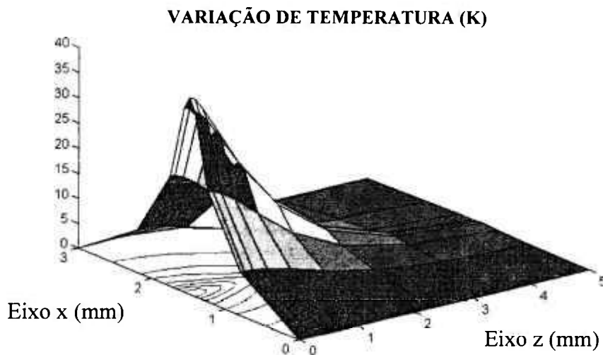
figura 13) Campo de variação de temperatura simulado (com o nosso programa) no plano central, y=1.5\text{mm} . Pode-se observar a forte queda da variação da temperatura ao longo do eixo z devido ao alto coeficiente de absorção desta amostra de Nd:YAG.
