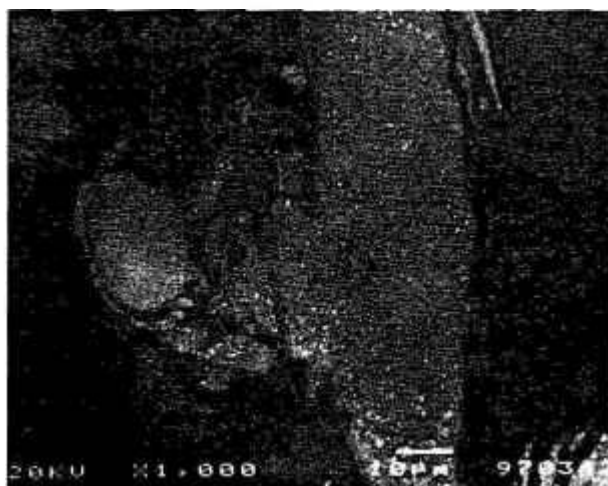
Figura 13- Pó processado durante 1h, conforme o teste nº 8 da tabela 4, preparado metalograficamente, mostrando partículas de NbC encravadas na matriz de AISI M2, elétrons retroespalhados. Significando que neste momento já havia a formação de um pó compósito.
