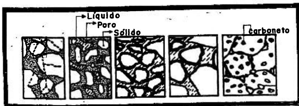
Figura 34- Esquema do mecanismo de sinterização do aço rápido M2 [12].
