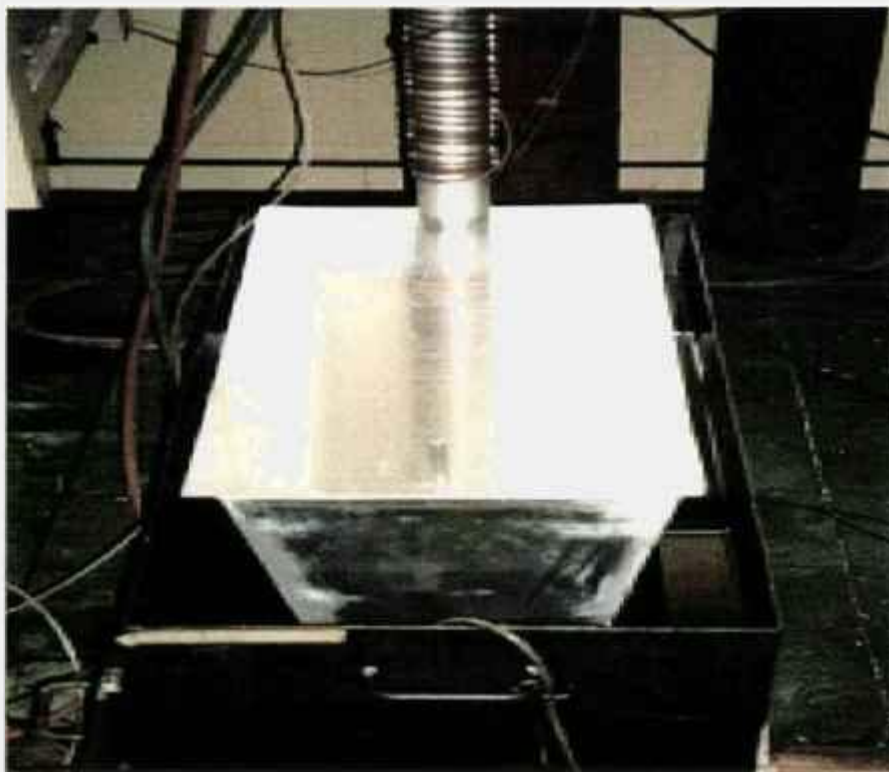
Figura 15 - Ilustração do molde metálico em alumínio com serpentinas de condensação para polimerização de detector plástico cintilador de grandes dimensões, pelo sistema aberto.
