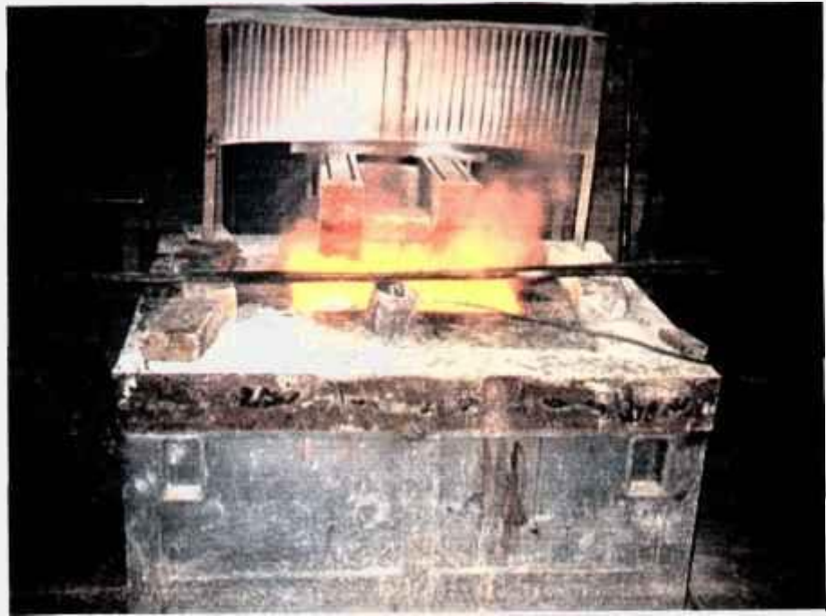
Figura 16: Forno utilizado para têmpera 1080°C / 1170°C por no máximo 10 minutos.
