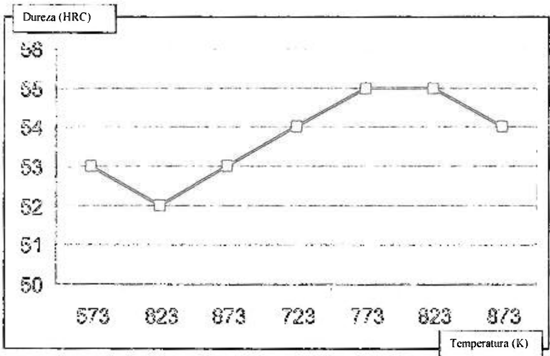
Figura 5.1: Curva de revenido para o aço AISI H13, determinada experimentalmente.
