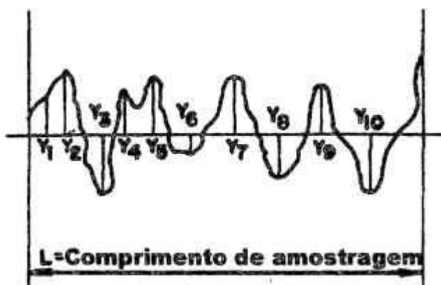
Figura 2.4: representação esquemática da medição de rugosidade Ra
