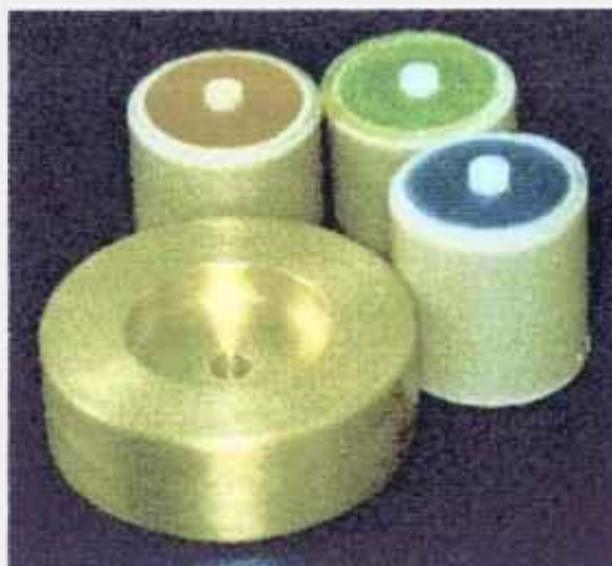
Figura 4 - Fotografia dos materiais antagonistas inseridos em tubos de PVC e torneados, juntamente com a matriz metálica. Escala 1:1.
