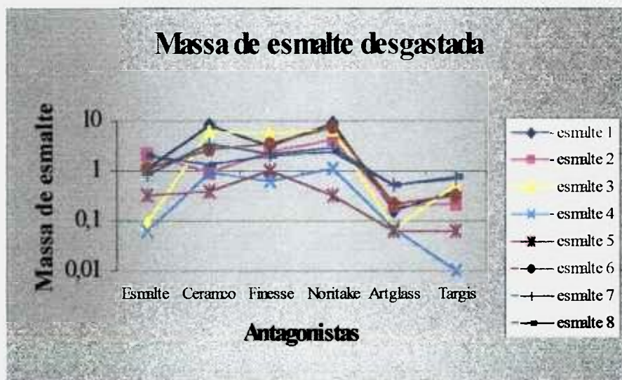
Figura 12 - Desgaste provocado pelos diversos antagonistas ( \mu\text{g}/\text{mm}^2 ).
