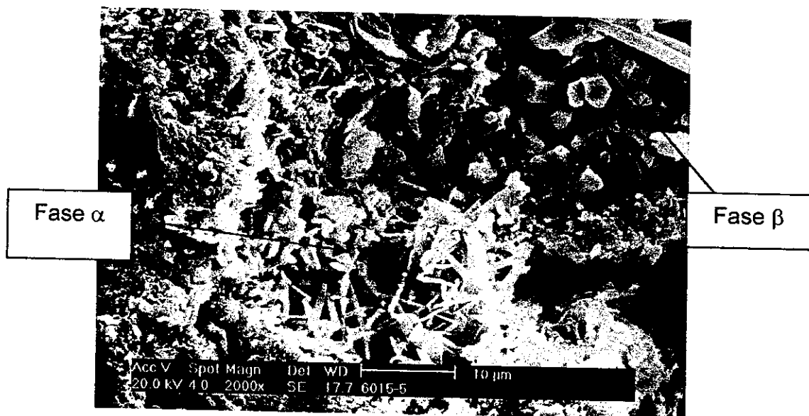
Figura 37. Micrografia de um poro da formulação 6015-V( adição de 1% de \text{Fe}_2\text{O}_3 )- Verificação de formação de fases \alpha e \beta
