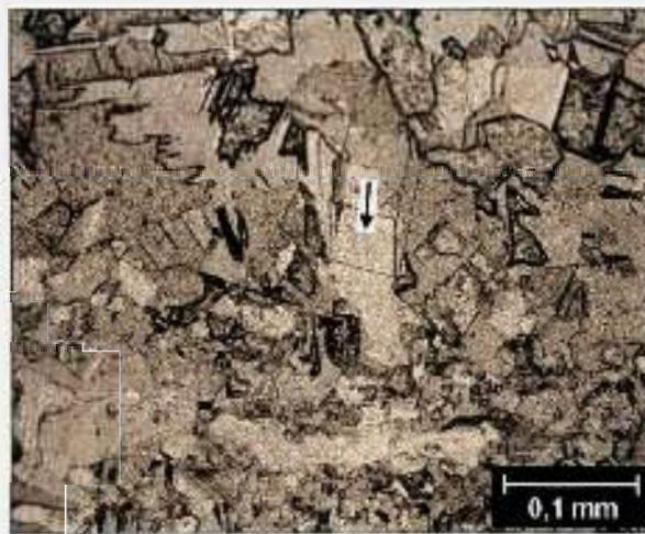
Figura 31 – Micrografia óptica da liga Cu-2,2%Ni-0,6% Be – TT. 425°C/6h – transversal ao plano de laminação.
