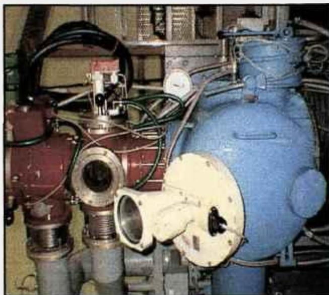
Figura 12– Forno de fusão por feixe eletrônico utilizado na produção de botões Cu-Ni-Be (UNICAMP)
