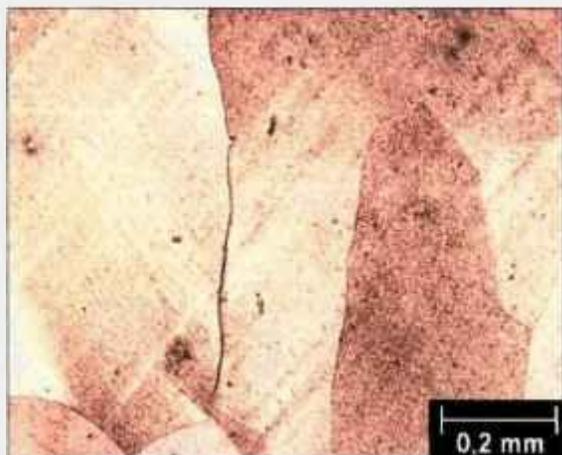
Figura 26 – Micrografia óptica da liga Cu-2,2%Ni-0,1%Be – solubilizada e laminada 35% – corte transversal
