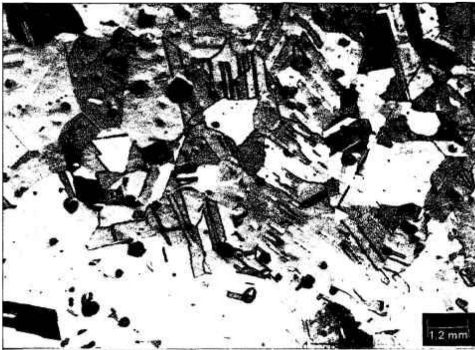
Figura 34 – Micrografia óptica da liga 0,3% Be – última etapa de tratamento térmico – 380°C/6h – perpendicular ao plano de laminação
