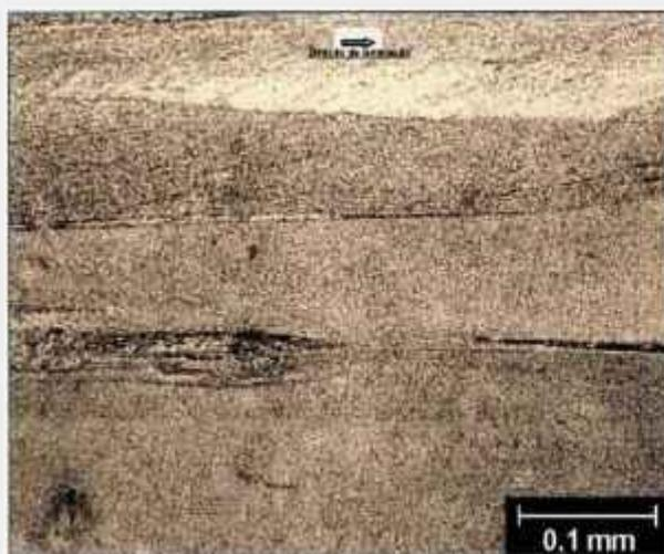
Figura 28 – Micrografia óptica da liga Cu-2,2%Ni-0,6% Be – após laminação 60% - corte longitudinal.
