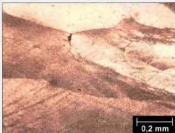
Figura 66 – Micrografia óptica da liga Cu-2,2%Ni-0,1%Be – TT final 380°C/6h – corte longitudinal.
