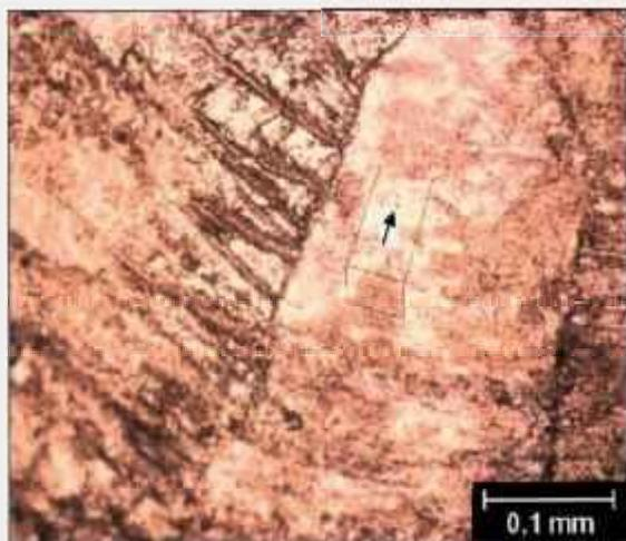
Figura 30 – Micrografia óptica da liga Cu-2,2%Ni-0,1% Be – TT. 425°C/6h – transversal longitudinal ao plano de laminação.
