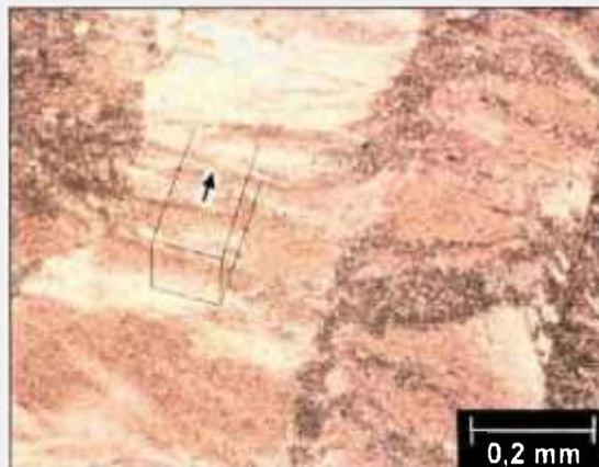
Figura 67 – Micrografia óptica da liga Cu-2,2%Ni-0,6%Be – TT final 425°C/6h – corte longitudinal.
