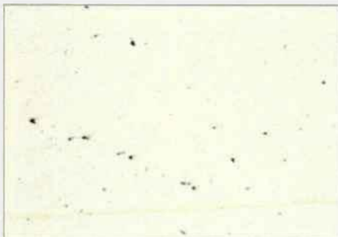
Figura 6.4: Micrografia óptica da superfície do aço 316L polida até pasta de diamante de 1µm. Aumento de 125X.
