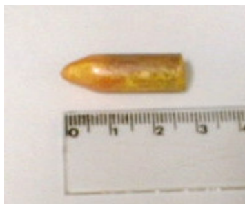
Figura 27 - Cristal de \text{PbI}_2 (25mmx8mm) obtido pela técnica de Bridgman após 200 passos (RZ200) de purificação por refinamento zonal.
