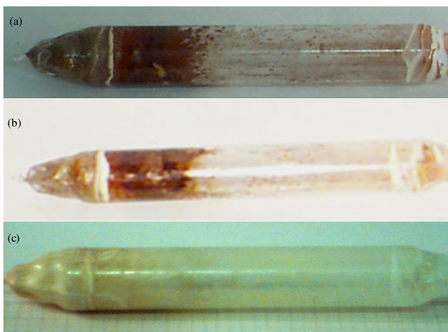
Figura 16 – Lingotes de PbI_2 após (a) primeira, (b) segunda e (c) terceira purificações.
