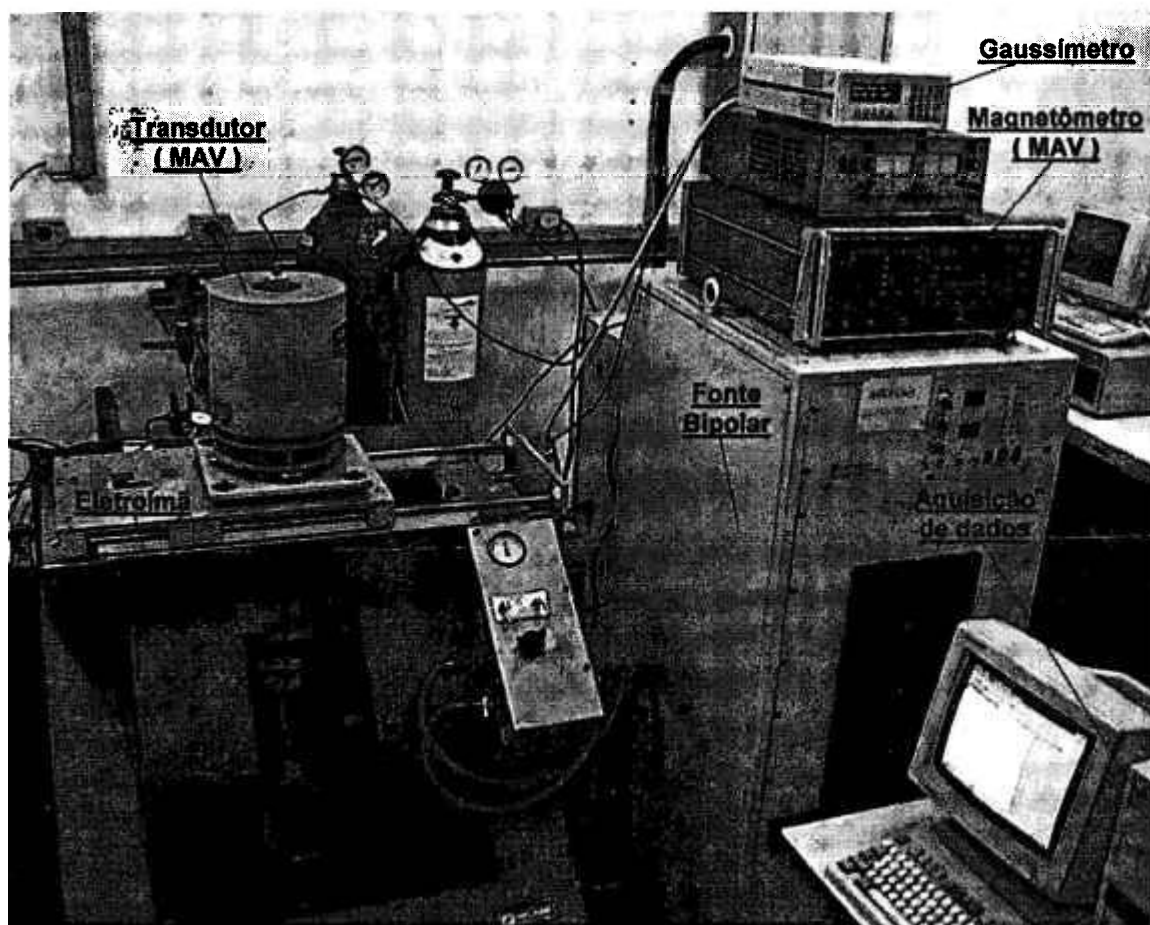
Fig.3.5 - Conjunto utilizado para a caracterização magnética por ( MAV ) dos filmes de SmCo.
