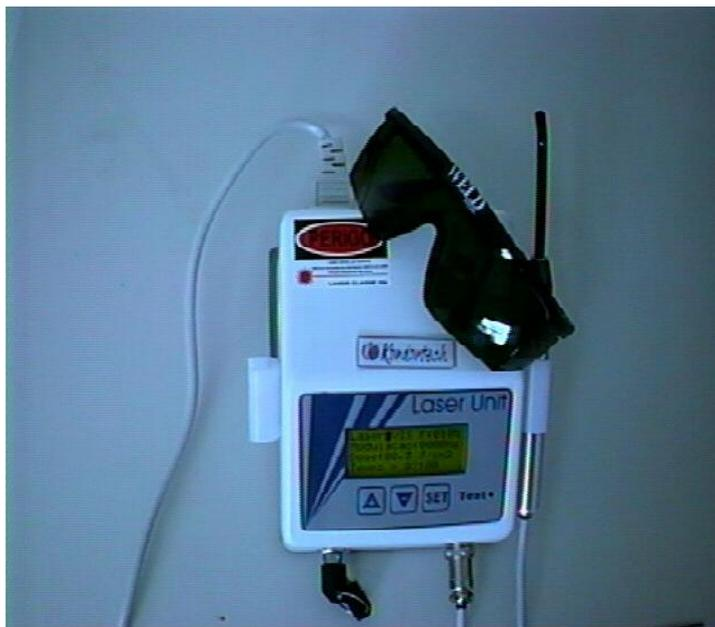
Figura 14: Fonte e painel de controle do sistema laser utilizado
