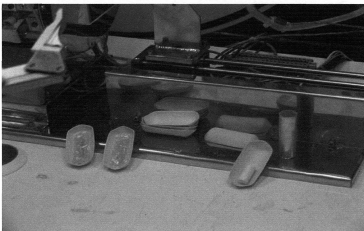
Figura 4.3. Vista dos alvos de \text{TeO}_2 antes e depois da destilação, no interior da célula de processamento de ^{131}\text{I}
