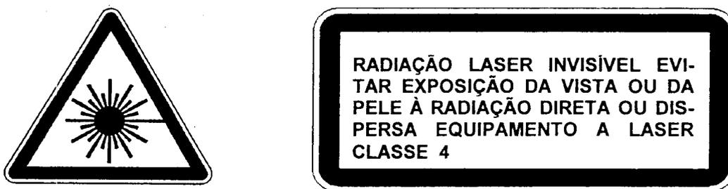
FIGURA 2 – SINAL DE ALERTA DA EXISTÊNCIA DE RADIAÇÃO LASER (ESQUERDA) E RÓTULO DECLARANDO A CLASSE DO LASER (DIREITA).
