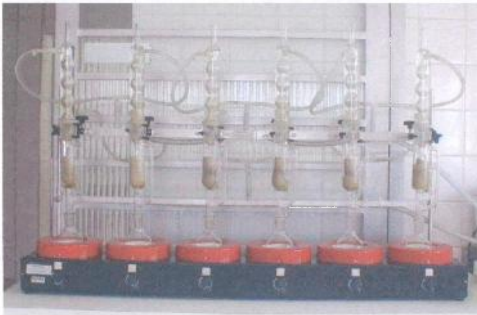
Figura 11 – Extrator Soxhlet utilizado para análise de massa mecânica
