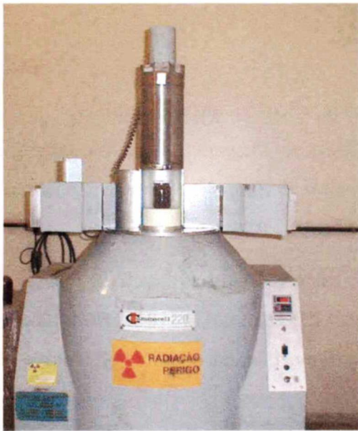
Figura 5 – Fotografias da fonte de ^{60}\text{Co} (Gammacell 220 AECL) utilizada para a irradiação das amostras de própolis
