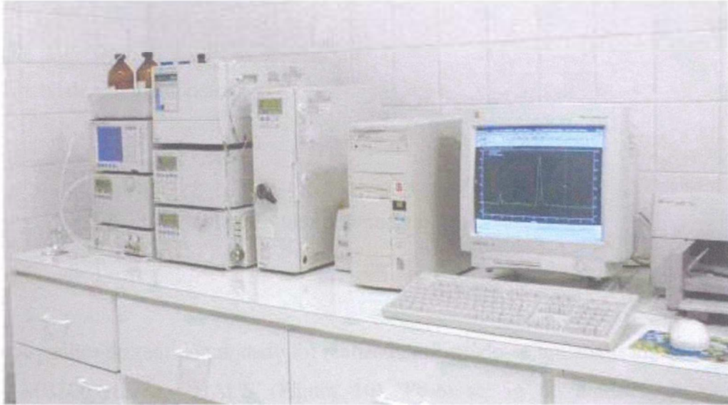
Figura 9 – Cromatógrafo HPLC utilizado para a determinação de compostos fenólicos da própolis
