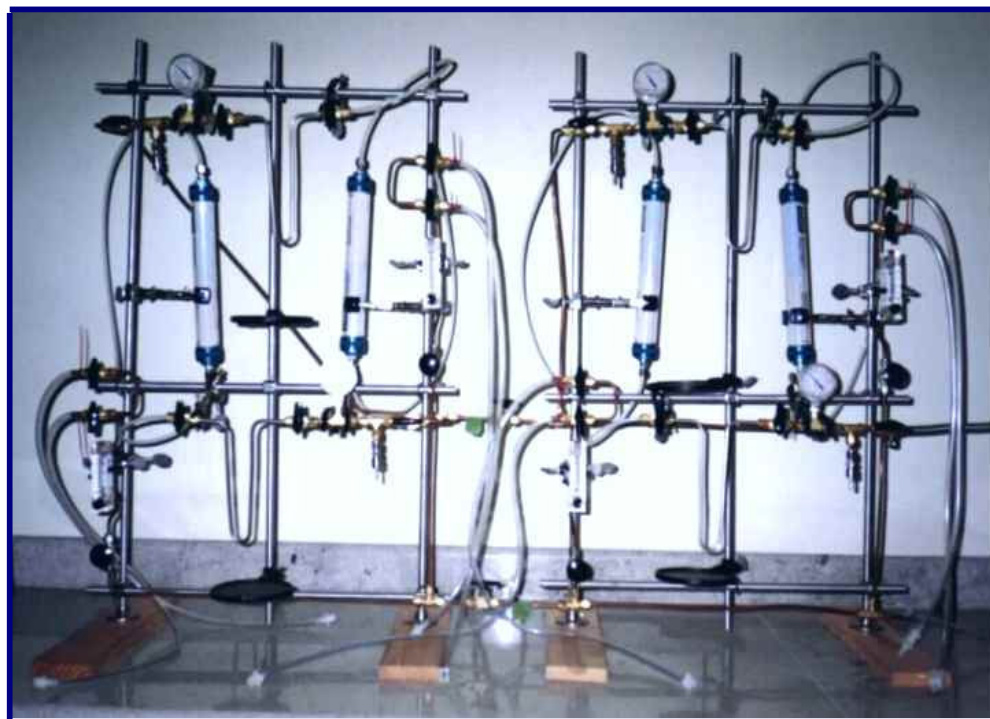
Figura 1.5. Linha de emanção com quatro sistemas de extração de ^{222}\text{Rn} em amostras de água do mar.
