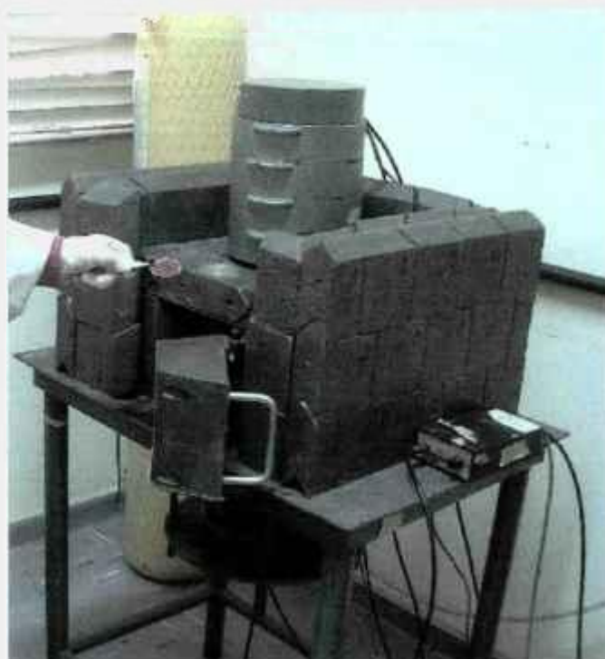
FIGURA 3.5 - Sistema 4\pi (PC) - NaI(Tl) com blindagem
