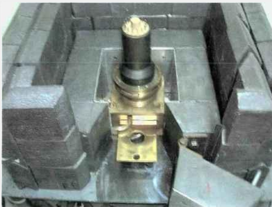
FIGURA 3.4 - Contador proporcional com o detetor NaI(Tl) acoplado, com parte da blindagem de Pb
