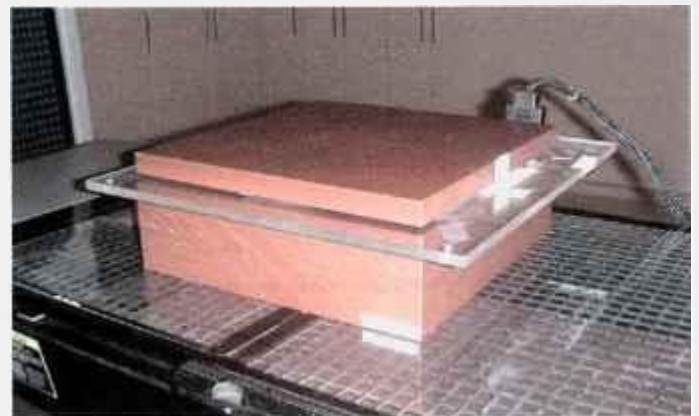
Figura 6.1.7: Detalhe dos detectores do sistema dosimétrico posicionados sobre a mesa de tratamento.
