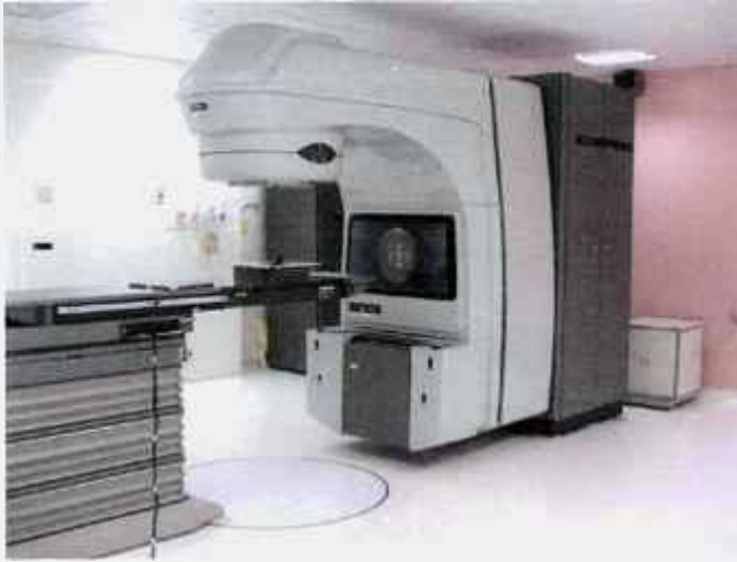
Figura 6.1.6: Acelerador linear Clinac 23EX com detectores posicionados na mesa de tratamento.
