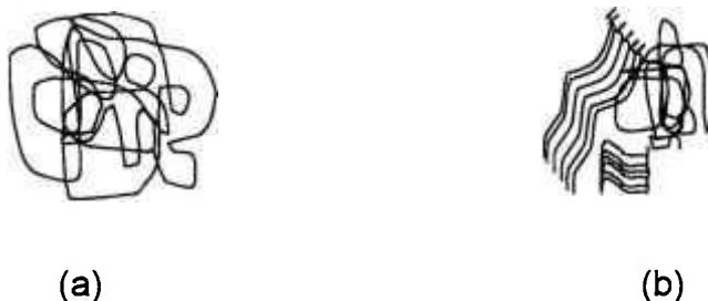
Figura 2.1. Esquema de estrutura amorfa (a) e semicristalina (b) de polímeros
