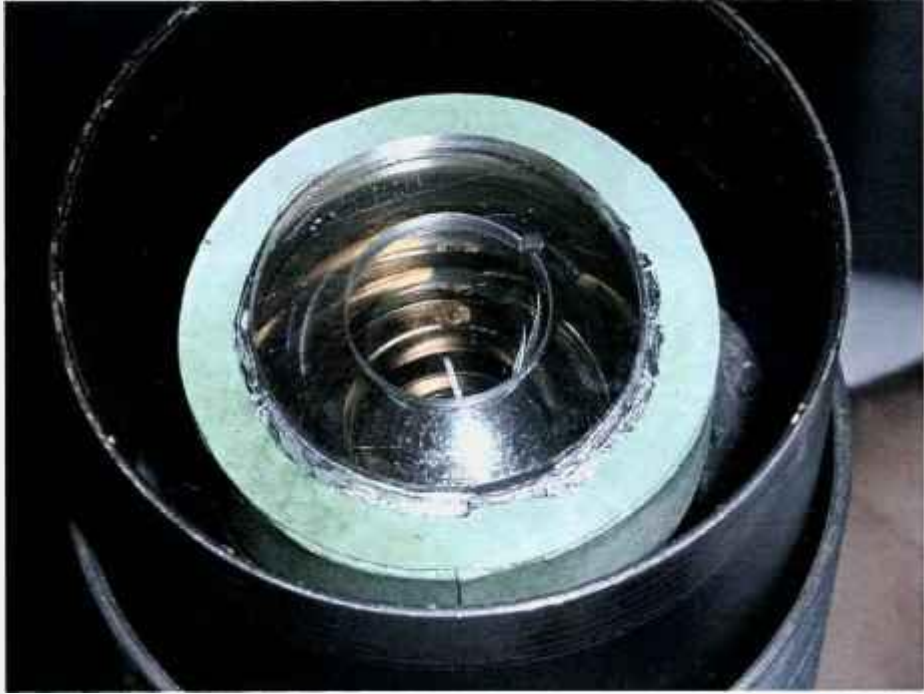
Fig. 5-2 - Cintilador acoplado na fotomultiplicadora
