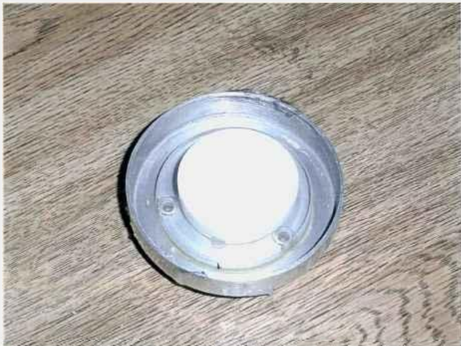
Fig. 5-3 - Parte superior do cintilador envolta em Teflon
