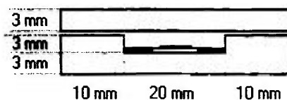
Fig 5-9 - Dimensões otimizadas do cintilador plástico
