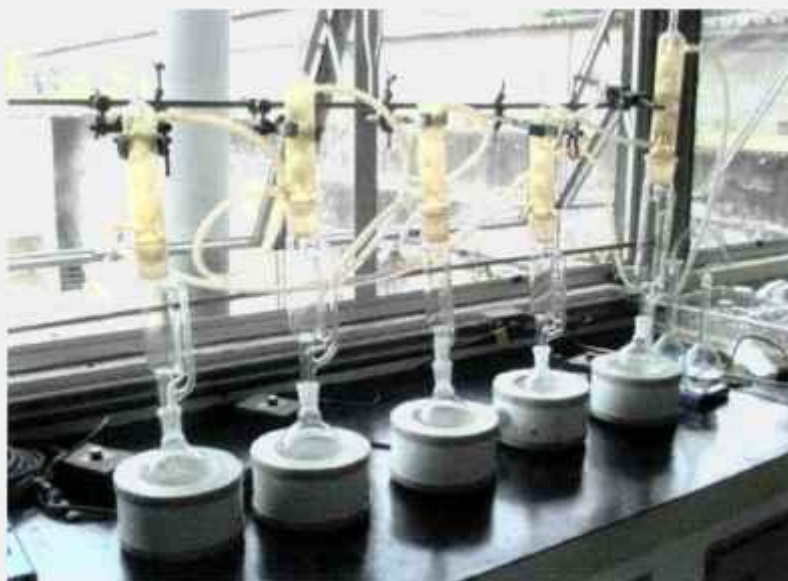
FIGURA 12: Colunas Soxhlet montadas para ensaio de solubilização
