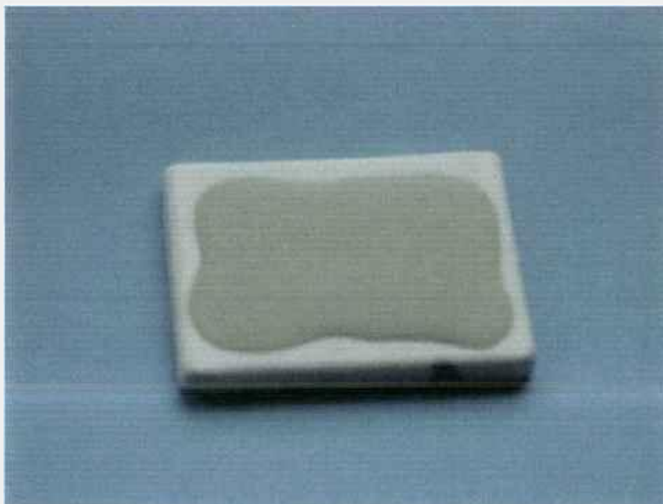
FIGURA 29 : Peça de alumina sinterizada, parcialmente recoberta com o esmalte, antes da queima.
