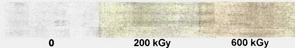
FIGURA 13 – Coloração das amostras de PA 6.6 com 30% FV sem irradiar e irradiadas com 200 e 600 kGy
