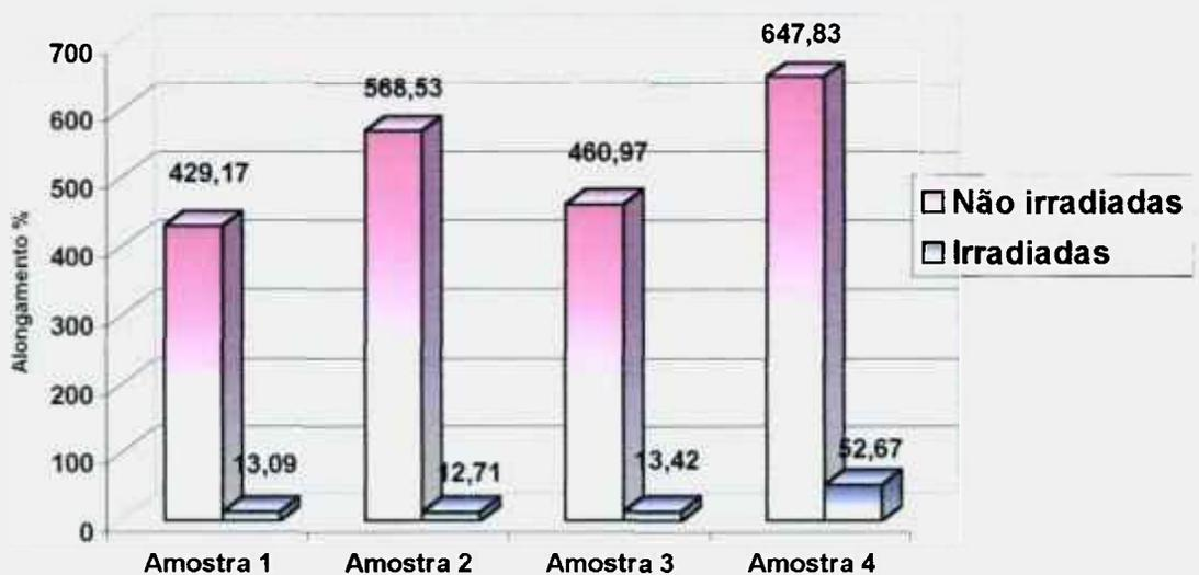
Figura 6 – Alongamento (%) das diferentes amostras de PET reciclado não irradiadas e irradiadas.
