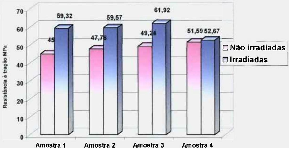
Figura 3 – Resistência à tração (MPa) das diferentes amostras de PET reciclado não irradiadas e irradiadas.
