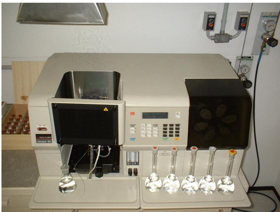
FIGURA 4.3 - Espectrofotômetro de absorção atômica PERKIN-ELMER
