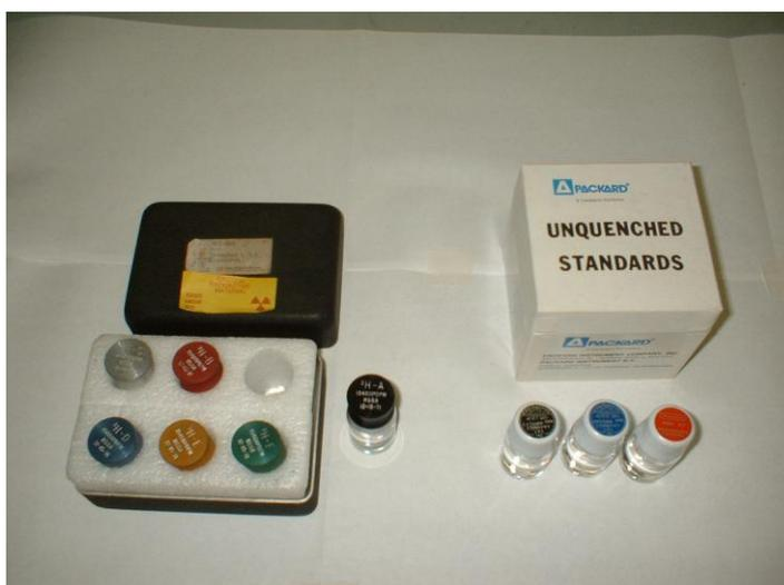
FIGURA 4.5 - Vials contendo os seis padrões com agentes de *quenching* e o padrão sem *quenching* da Packard, utilizados na curva de eficiência para determinação de trício.
