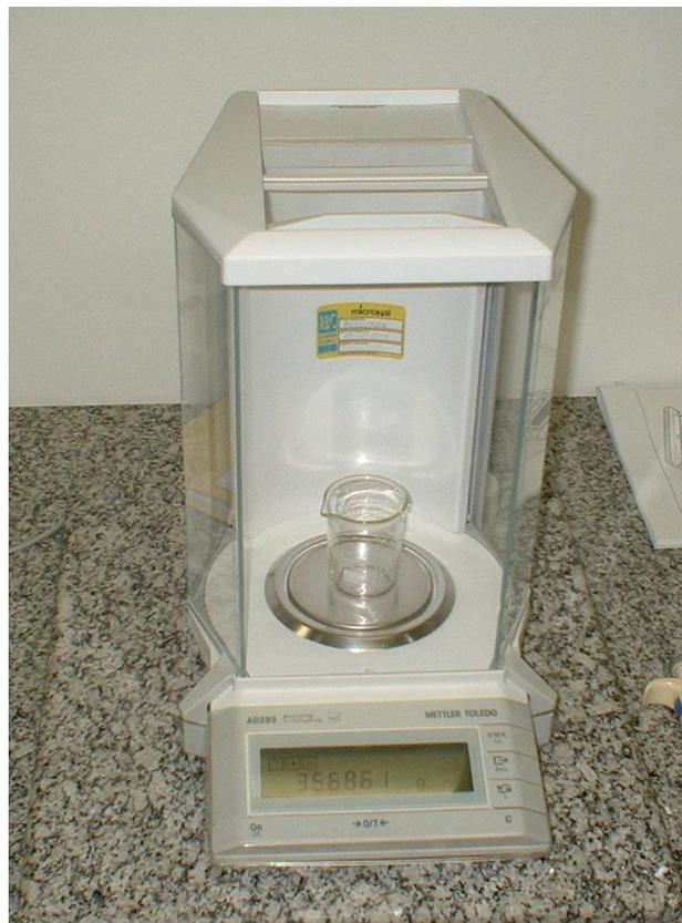
FIGURA 4.2 - Balança METTLER TOLEDO AG 285 usada para preparação das soluções padrões
