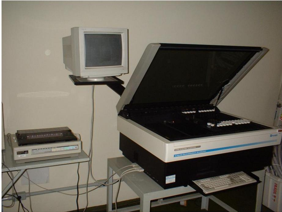
FIGURA 4.1 - Cintilador líquido Tri-carb 2100 TR da Packard
