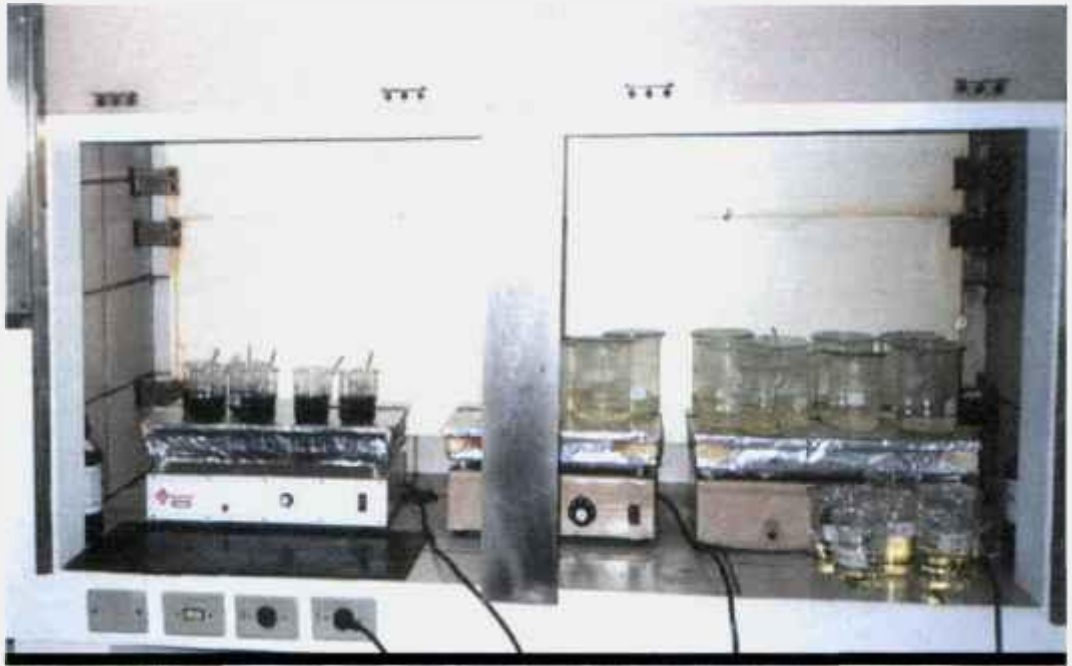
FIGURA 14 – Lixiviação das fibras de acrílico impregnadas com \text{MnO}_2 para posterior separação radioquímica do ^{226}\text{Ra} e do ^{228}\text{Ra} .
