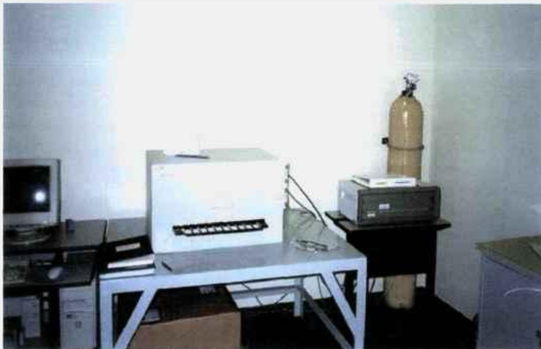
FIGURA 13 - Detector proporcional de fluxo gasoso, de baixa radiação de fundo, EG&G Berthold, LB 770, utilizado para medida alfa e beta total dos isótopos ^{226}\text{Ra} e ^{228}\text{Ra} .
