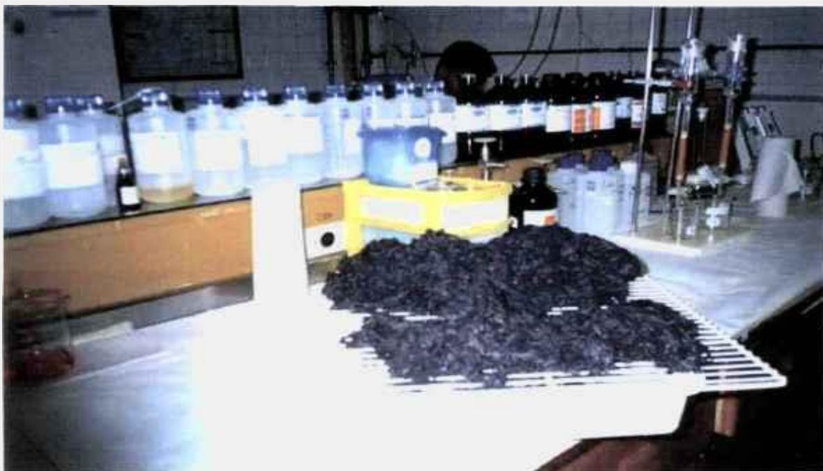
FIGURA 7 - Fibras de acrílico impregnadas com MnO 2 para a utilização nas colunas adsorvedoras de isótopos de rádio.
