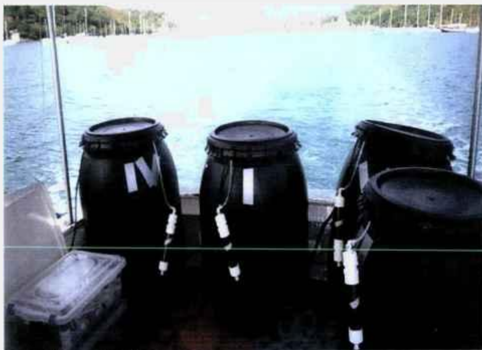
FIGURA 9 - Percolação das amostras de água do mar através de colunas de fibras de acrílico impregnadas com MnO 2 , para pré-concentração do rádio (Enseada do Flamengo, Jan 2002).
