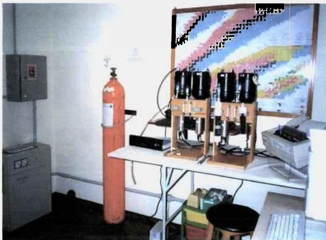
FIGURA 12 – Sistema de coincidências atrasadas, com células de cintilação de 1,1 L utilizado para determinação de ^{223}\text{Ra} e ^{224}\text{Ra} nas amostras de água do mar.
