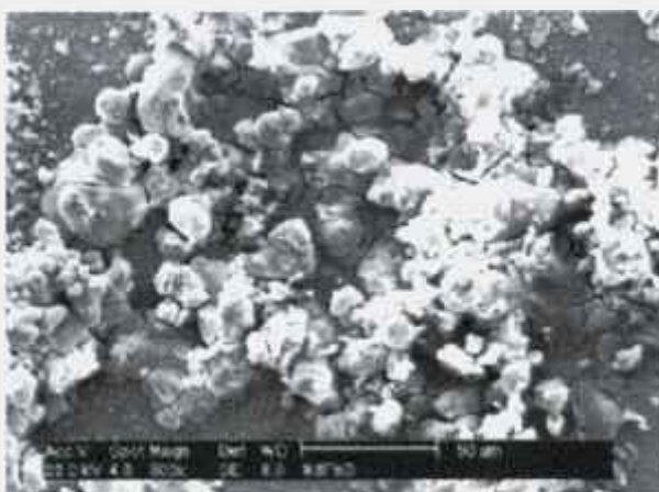
Figura 3.10.7- Micrografia da superfície da amostra mostrando produtos de corrosão.(aumento 500 X)
