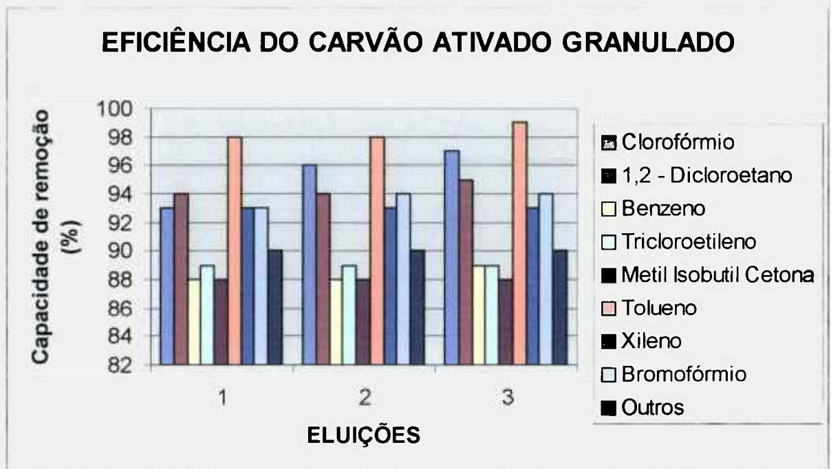
FIGURA 11 – Eficiência de adsorção do carvão ativado granulado com amostra real após eluições consecutivas
