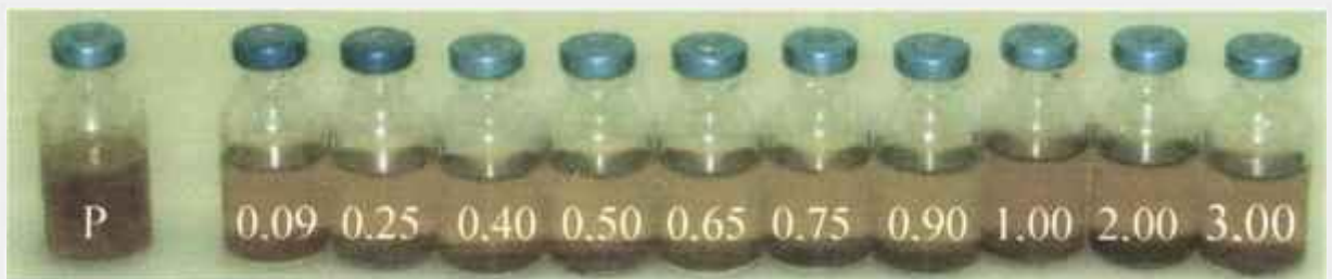
FIGURA 14 – Remoção da cor pelo carvão ativado pulverizado/quantidade de carvão pulverizado em gramas
