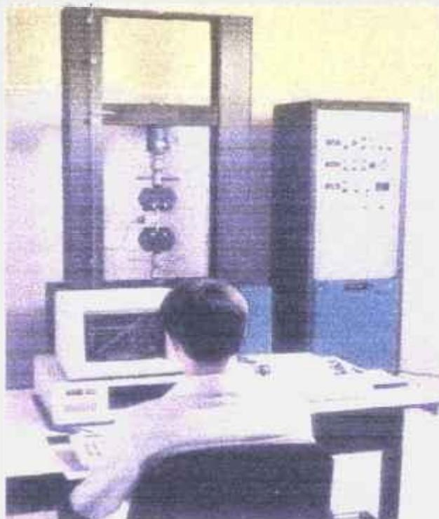
**FIGURA 08:** Equipamento Instron para ensaio de Resistência à Tração-Dinamômetro, com extensômetro.
