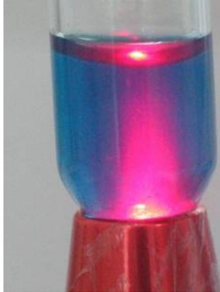
Fig. 3 - Irradiação na parte inferior do tubo de ensaio com verde malaquita em solução, ilustrando a absorção do sistema contendo suspensão bacteriana e corante.
