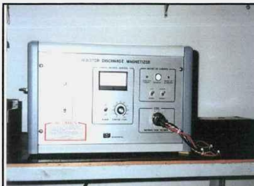
Figura 3.9 - Magnetizador utilizado para orientação das partículas (etapa anterior à prensagem isostática) e para saturação das amostras após sinterização, modelo LDJ 450-20C.
