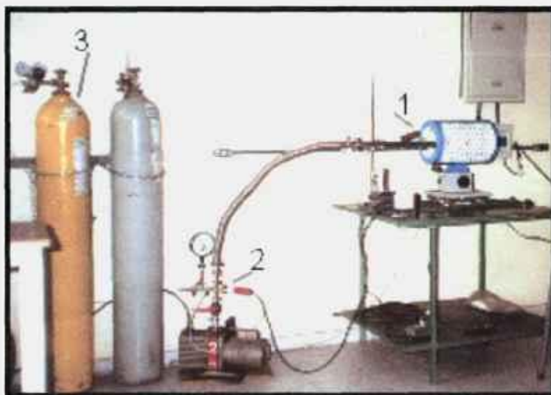
Figura 3.3 - Sistema utilizado para decrepitação por hidrogênio da liga magnética. (1) retorta; (2) bomba de vácuo e (3) Cilindro de hidrogênio.
