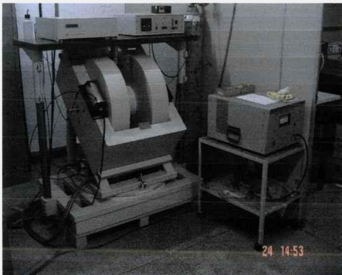
Figura 13. Espectrômetro de Ressonância Paramagnética Eletrônica (RPE). Bruker EMX pertencente ao Instituto de Física da USP.
