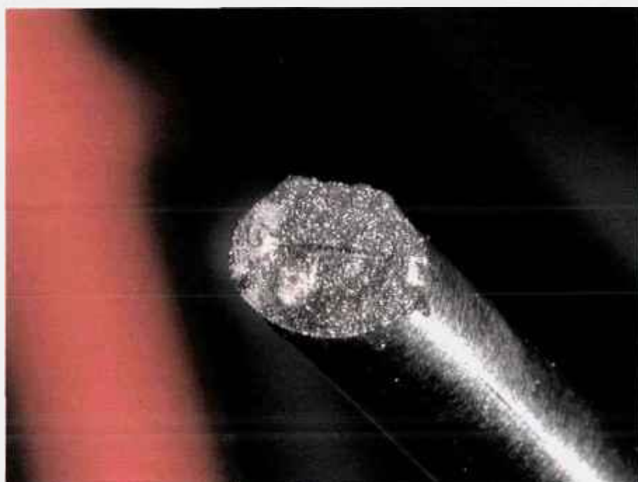
Figura 27: Fotografia representativa da ponta do termopar Nanmac coberto com uma camada de corante à base de carvão depois do único disparo do laser de diodo. A irradiação do laser removeu o carvão, formando a listra que pode ser vista no local em que feito o disparo.
