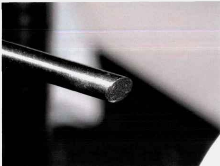
Figura 26: Fotografia representativa da ponta do termopar Nanmac coberto com uma camada de corante à base de carvão antes do único disparo do laser de diodo.
