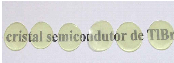
Figura 17 – Fatias de diferentes cristais de TlBr.
