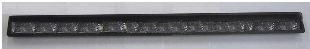
Figura 15 – Barquinha de carbono vitrificado contendo material da Merck após 2 passos de purificação (FZ19).
